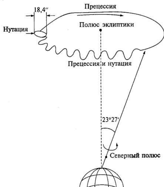
Рис. 3.11. Схема движения оси вращения Земли в пространстве (по Н. С. Сидоренкову, 2002)
