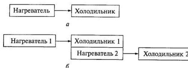
Рис. 4.9. Модели (а, б) геофической тепловой машины
